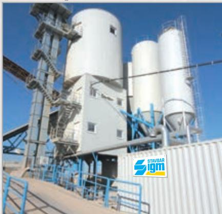
Obrat betonarna proizvaja transportne betone za potrebe gradbene operative in betone za izdelavo betonskih prefabrikatov podjetja Stavbar IGM. Proizvodni program obsega izdelavo:
