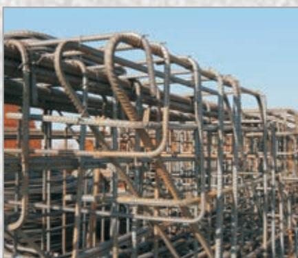
Proizvodni program PC železokrvnica je izdelava, rezanje in krivljene armature za armiranje betona in polaganje armature na gradbiščih.
