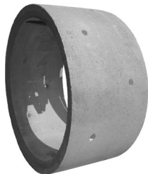
CEV FI 200 Teža: 2200 kg Cev je minimalno armirana (4 varnostni obroči, 6 pokončnih palic)
